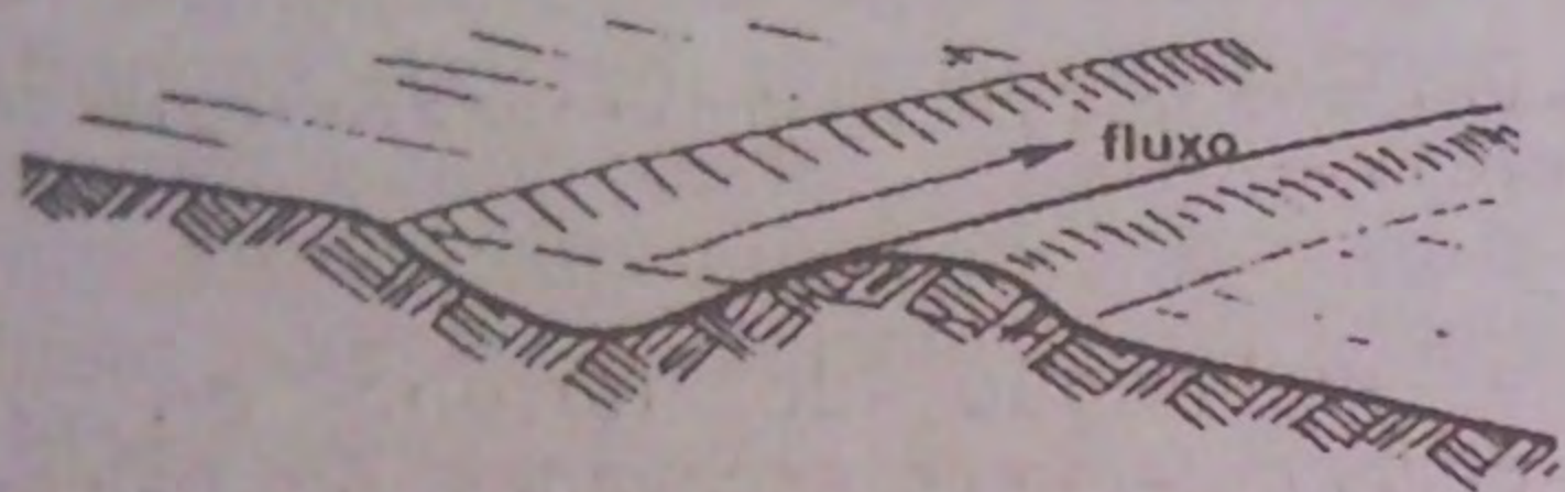
Figura 2.19 Drenos de divergência fluem dos córregos para açudes, ou coletam o escoamento superficial de água. Estes são importantes para qualquer sistema de coleta de água da chuva.
